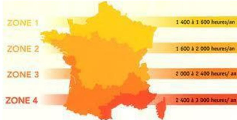
En zone 1, on considère généralement qu'1 m<sup>2</sup> de panneau solaire photovoltaïque couvre 1,7 % des besoins électriques (éclairages et autres besoins excepté le chauffage et la climatisation) d'une maison individuelle de 4 personnes (soit environ 2 500 kWh/an).
